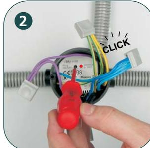
2 Die Programmierstaste wird betätigt (die rote LED und die angeschlossene Lampe sind EINGeschaltet)
