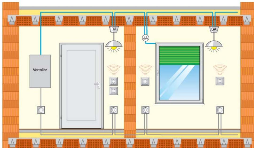
Hierbei muss KEIN größerer Installationsverteiler vorgesehen werden. Die Aktoren sind teils in den Abzweigdosen (Jalousie), teils in den Lampenabdeckungen (Beleuchtung) eingebaut.
